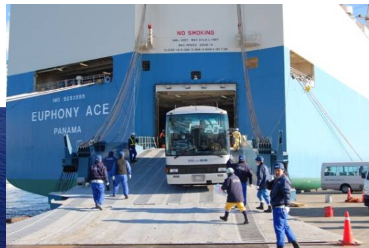
← ↑ “Euphony Ace”(2005年竣工) 風圧抵抗低減船型、太陽光パネル搭載など、 エコシップの先駆け的自動車船 全長200m、積載台数6,400台
