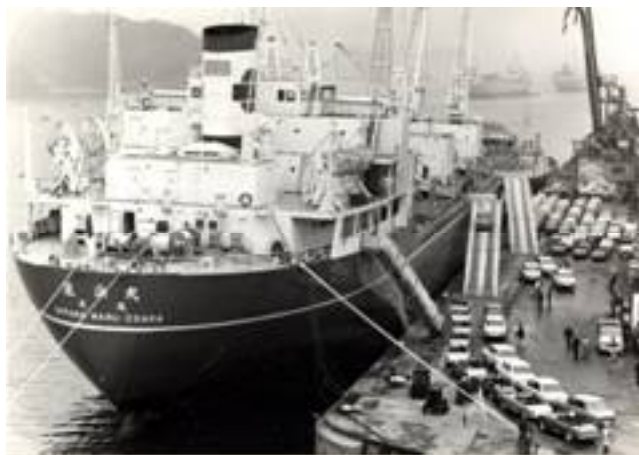
← “追浜丸”(1965年竣工) 日本で初めてRORO方式の自動車専用荷役装置を 設けた船 全長142.5m、積載台数1,200台
