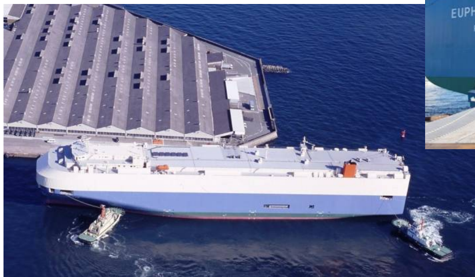
← ↑ “Euphony Ace”(2005年竣工) 風圧抵抗低減船型、太陽光パネル搭載など、 エコシップの先駆け的自動車船 全長200m、積載台数6,400台
